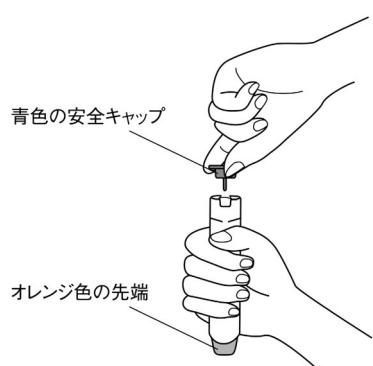
(2) オレンジ色のニードルカバー先端を下に向けて握り（注射器の上下どちらの端にも親指をかけないで）、青色の安全キャップを外す。
