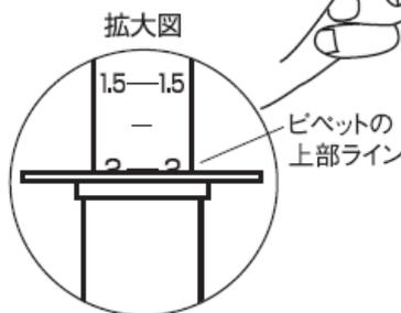
④ 片手でピンを押さえ、もう一方の手でピペットの上部（長形状の持ち手）を持ちながらピペットをゆっくりと取り出してください【図4】。
