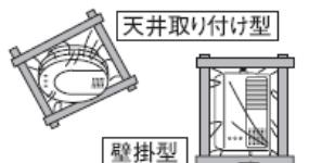
●直接火災報知器に霧があたらない位置で使用してください。霧が直接あたると火災報知器(煙を感知するタイプ)が作動することがあります。
