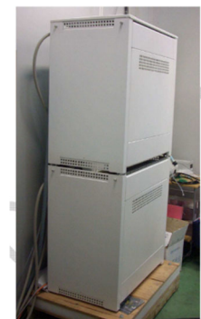
(3) 高電圧発生装置
