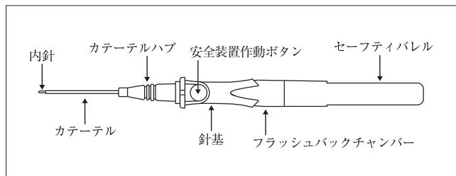
インサイト (N) オートガード及び 24G, 22G, 20G のインサイト オートガードは内針に側孔が設けられており、低い静脈圧下でフラッシュパックチャンバーへの血液の逆流を待たずして、血管確保を刺入部で確認することができる。
